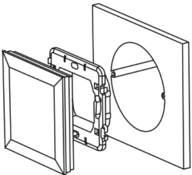
Извлеченнную монтажную панель установить в подрозетник Ø60мм. Лицевую панель установить на монтажную панель совместив 4 клина и 4 прямоугольных отверстия, после чего аккуратно надавить до упора.
