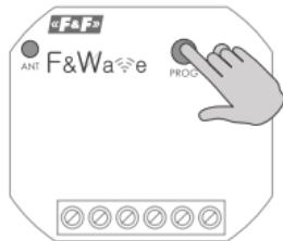
После правильного подключения приемника нажмите и удерживайте кнопку PROG до тех пор, пока устройство не активирует выходную цепь, и индикатор связи не погаснет.
