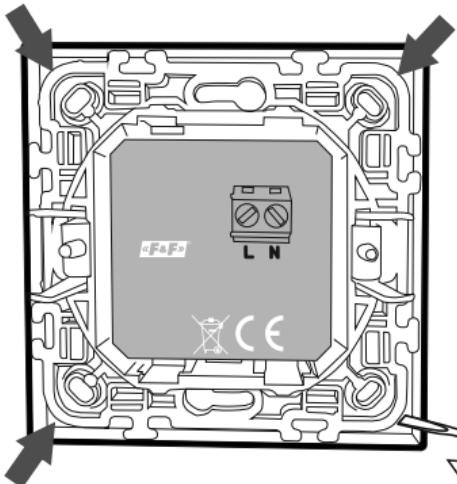
Для установки сенсорного передатчика в монтажную коробку/подрозетник необходимо отделить лицевую панель от монтажной. Для этого необходимо по 4-м углам (показано стрелками) монтажную панель поддеть «плоской» отверткой и слегка надавить.
