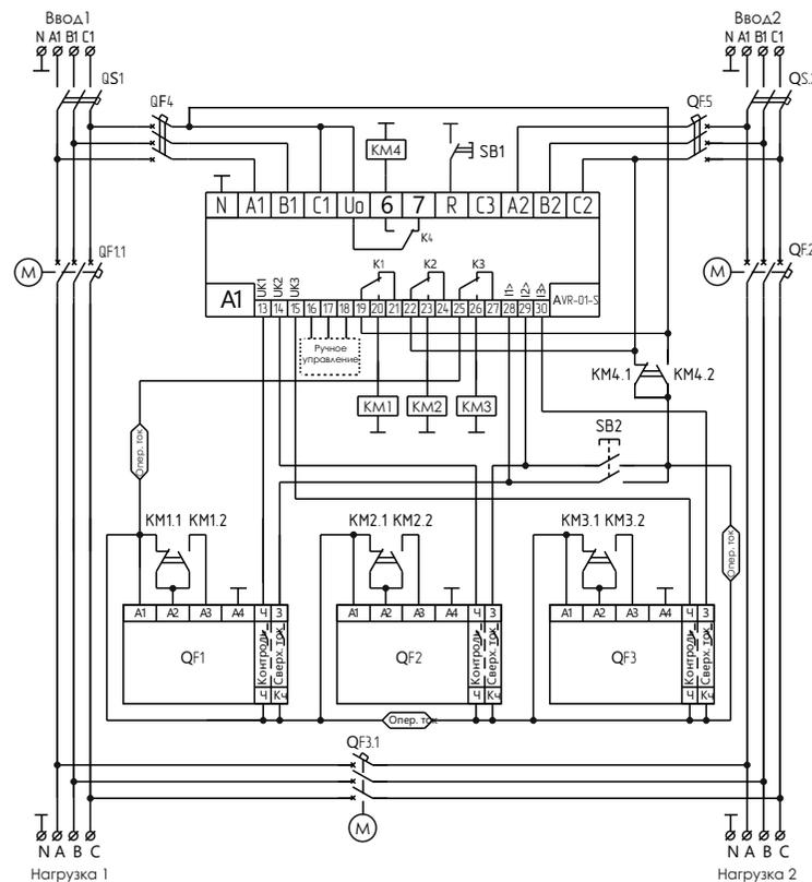
SB1 – кнопка сброса после аварийного отключения;
